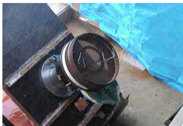
写真 - 5 降雨強度を下げるためにふるいを掛ける
